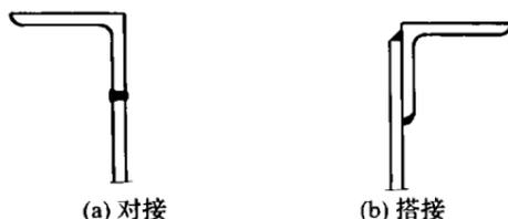
图 6.2.1 包边角钢与罐壁连接接头
